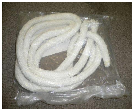
図 3.6 アスベストリボン（左）及び アスベスト紐（右）
