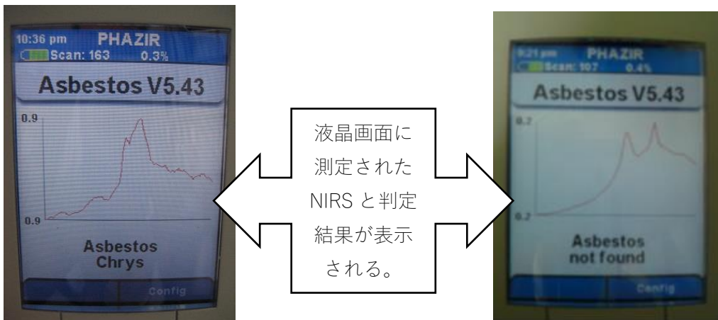
図 1. アスベストアナライザー概観
