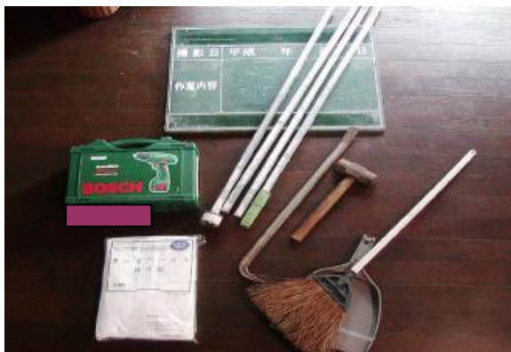
図 4.2 調査用品の例（改修や解体の事前調査における用品の例）
