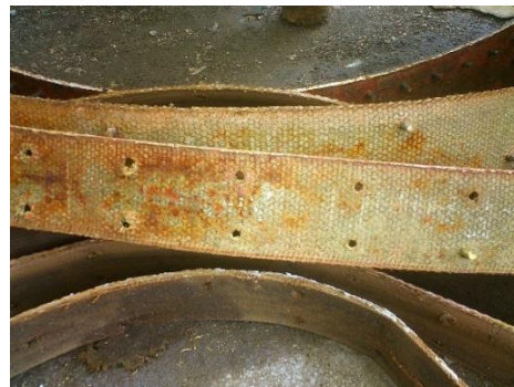
図 3.11 ウインドラスのブレーキライニング
