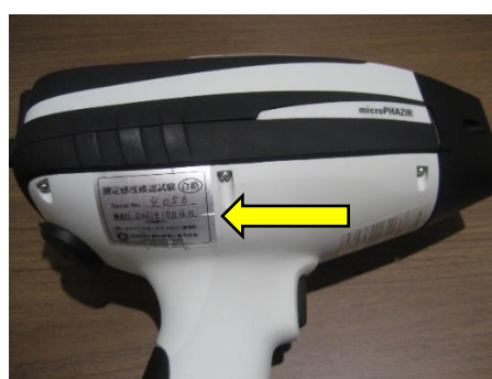
図 4. 測定感度確認試験合格証貼付例
