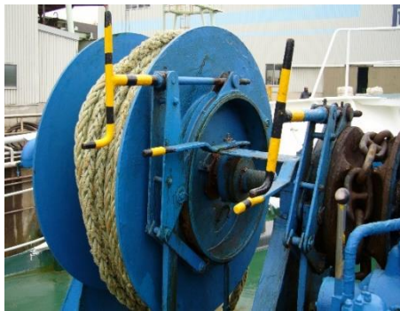
図 3.11 ウインドラスのブレーキライニング
