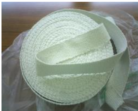
図 3.6 アスベストリボン（左）及び アスベスト紐（右）
