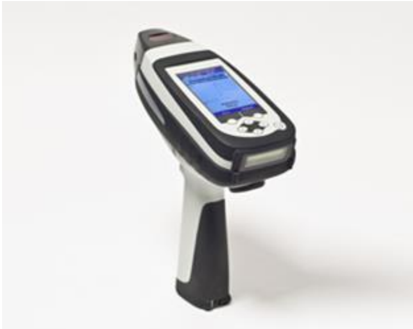
図 1. アスベストアナライザー概観
