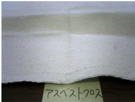
図 3.5 アスベストクロス（左）及び アスベストクロスを巻き付けた蒸気配管（右）
